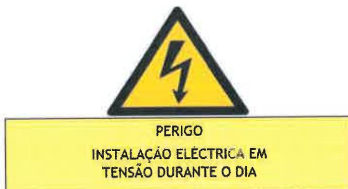
Figura 1 - Aviso modelo da existência de tensão do lado DC (sistema fotovoltaico)
