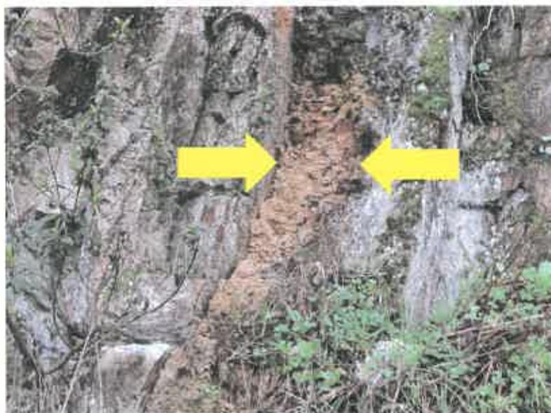
**Fotografia 16 – Filão de material rochoso muito alterado – grau de alteração W4 – encaixado no maciço rochoso medianamente alterado – grau de alteração W3 – (Geovia, 23 de dezembro de 2022)**
