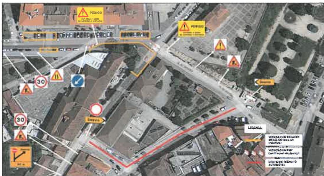
Fig.1 – Planta do Condicionamento de trânsito para a execução da empreitada
